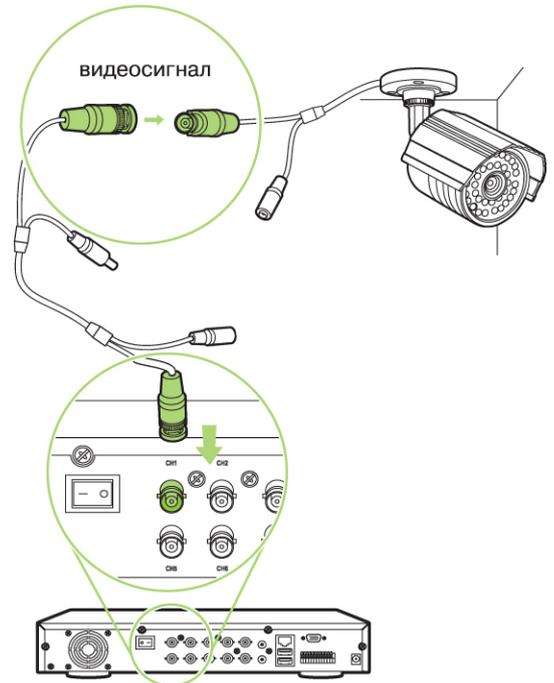
Схема удлинения соединительного шнура показана на обороте.
